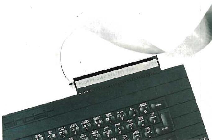
**Il disc drive si collega molto facilmente allo Spectrum con l'interposizione dell'apposita interfaccia, che si innesta direttamente nel connettore della user port.**
